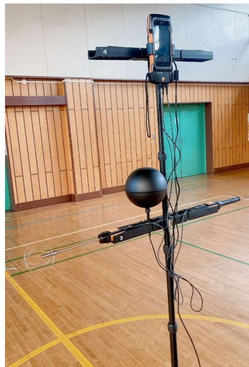
室内 PMV：PMV 計 Testo400 (床高さ 1.1m)
