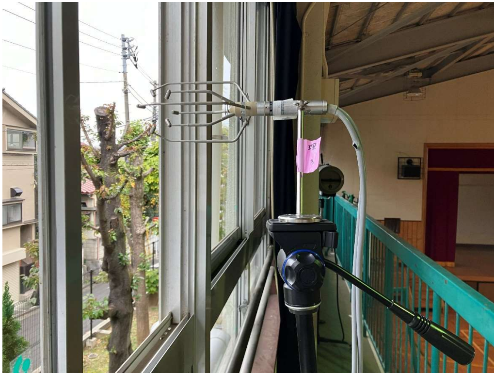
上部窓風向風速：超音波風速計
